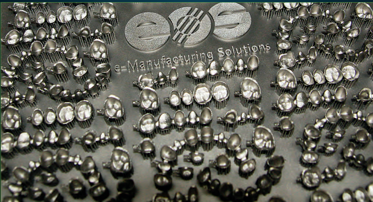
Коронки и мостовидные протезы печатаются на промышленных 3D-принтерах по металлу компании EOS (Германия)
